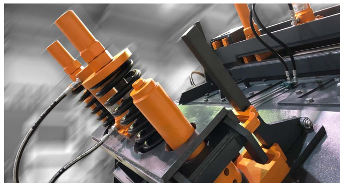
Quetschspalteinstellung mit Abstandplatten und hydraulischer Unterstützung
